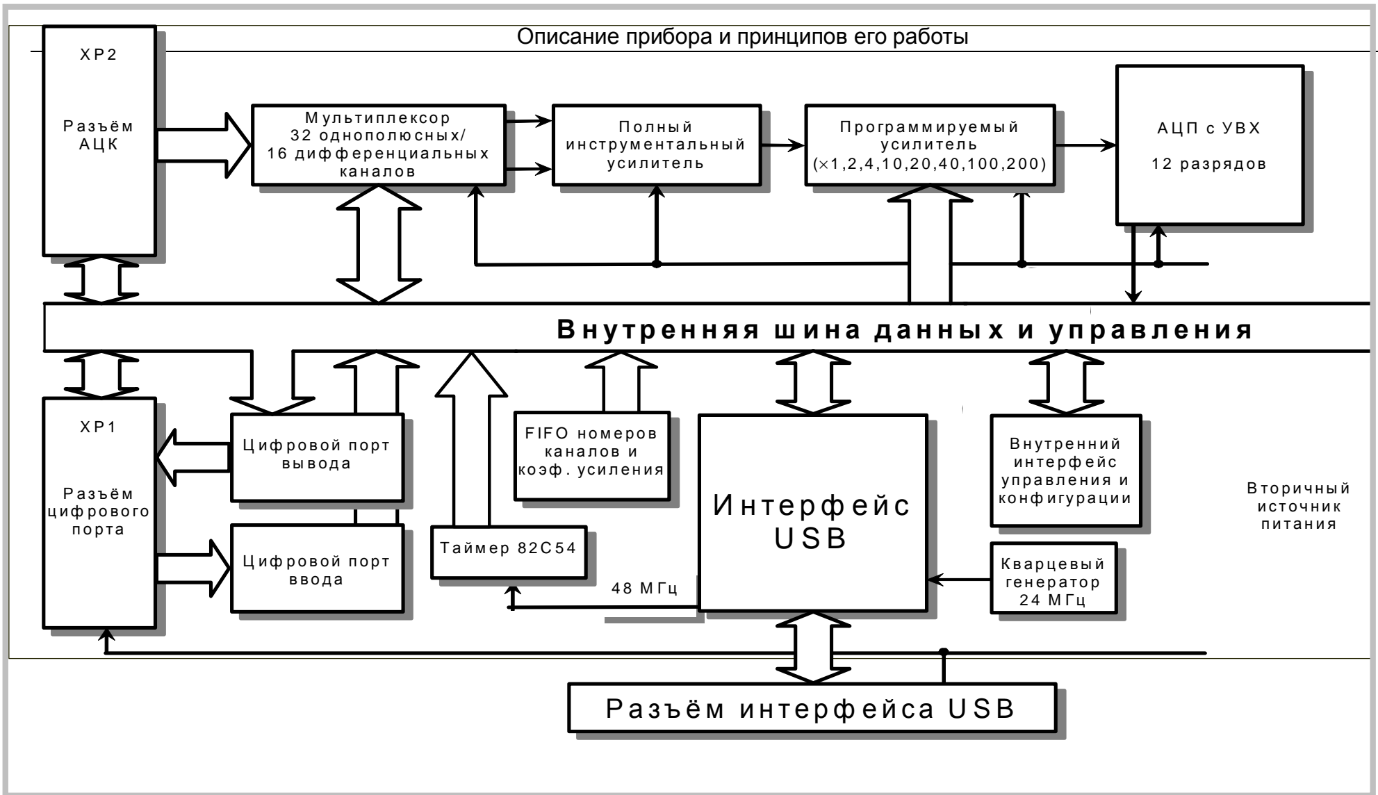
Функциональная схема ЛА-2USB
